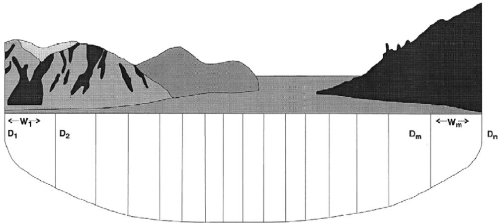
$$Q = \left( \frac{D_1 + D_2}{2} \right) \left( \frac{V_1 + V_2}{2} \right) W_1 + \dots + \left( \frac{D_m + D_n}{2} \right) \left( \frac{V_m + V_n}{2} \right) W_m$$
